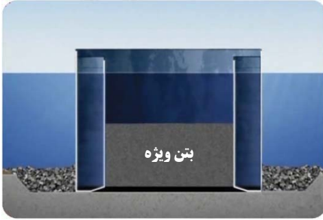
شکل ۲-۲۱ پر کردن هسته کیسون با بتن ویژه
